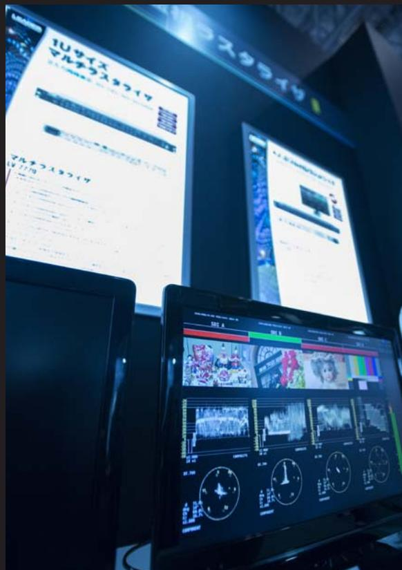
性に優れた9インチフルHDの液晶表示器を搭載し、高品位ピクチャーモニターとしても使用できる。SDI出力端子およびDVI出力端子を装備しているため、画面表示を外部フルHDモニターに表示することも可能だ。また3G-SDIの4入力同時表示や3G-SDIデュアルリンクによる「1080×1920(2048) / 60p RGB 4:4:4フォーマット」に対応する点も大きな特徴である。
